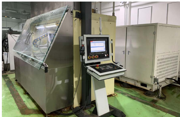
图 5 前混合水射流改性系统
